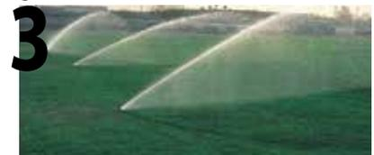
Rain Bird's große Auswahl an Rain Curtain Düsen bietet optimale Gleichmäßigkeit der Wasserverteilung über die gesamte Wurfweite (0,12-8,24 m³/h / 4,6-24,7 m); dies garantiert eine hohe Flexibilität bei der Planung.
